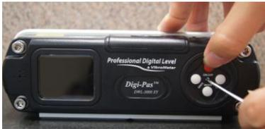
确保 DWL3000XY 产品处于关闭状态.同时按下 CAL 及 ON/FF 按钮, 液晶屏会出现“Calibration 1”。
