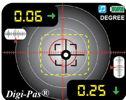
移动的牛眼随检测位置变化而改变，类似传统的水泡。绿色箭头指向偏高方向。
