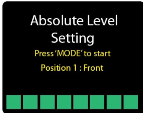
将产品置于待侧面，按下 MODE 按钮，开始检测，然后直到进度条满格。
